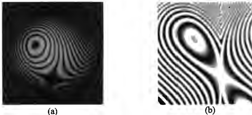
Figura 5.12. Patrones de interferencia correspondientes a una lente: (a) experimentalmente obtenido en nuestro interferómetro de desplazamiento vectorial con los parámetros de desplazamiento \Delta x = 0.65 mm, \Delta y = 3.25 mm. (b) Simulación utilizando los mismos parámetros de desplazamiento identificando las siguientes aberraciones de la lente bajo prueba: -1\lambda de inclinación, -1.8\lambda de coma, -1\lambda de astigmatismo, y -0.05\lambda de esférica.
