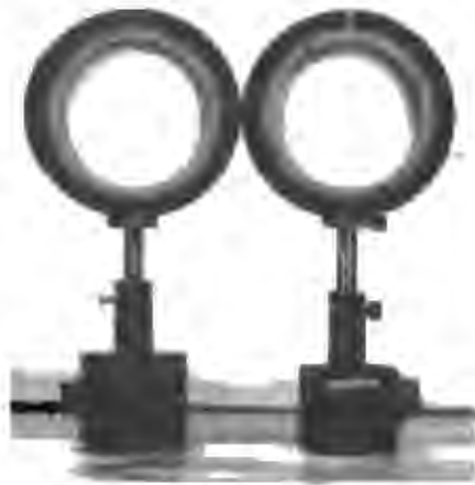
Figura 4.1. Las monturas rotatorias prismas facilitan el montaje y alineación de los prismas de desviación variable.
