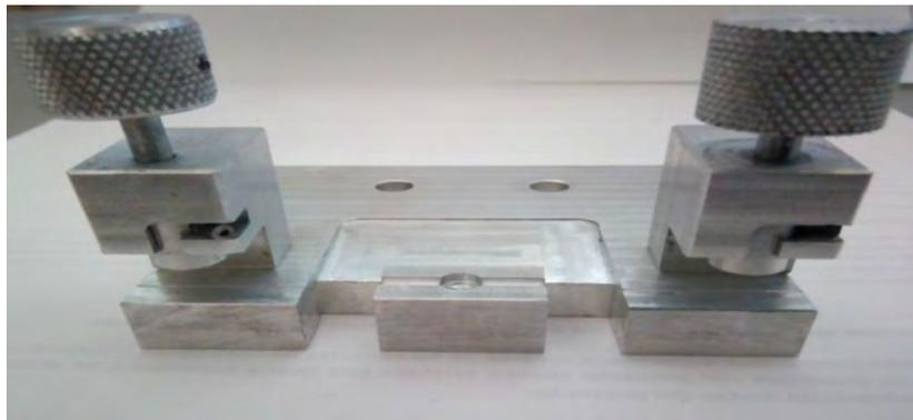
*Figura 3. 21. Montura (7.5x6x1 mm) con celda de prueba (diámetro 5 mm) para el análisis experimental de un dispositivo de fibra óptica a índice de refracción con sujetadores.*
