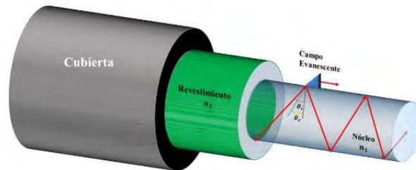
Figura 2. 5 Propagación de la luz en una fibra óptica y el fenómeno de reflexión total interna.
