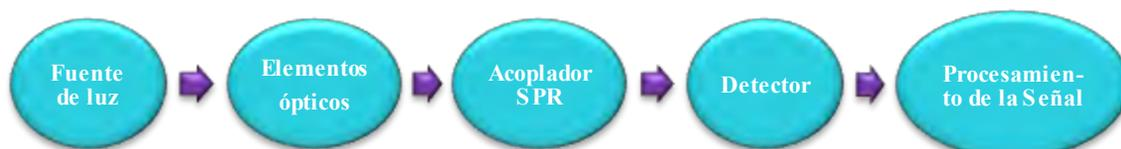
Figura 2. 3. Estructura general de un sistema de resonancia de plasmón superficial.
