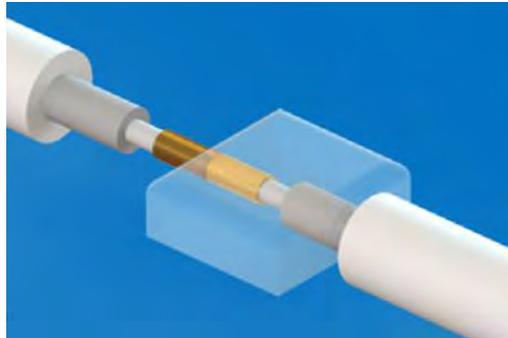
Figura 4. 5. Representación del sensor de fibra óptica propuesto con dos canales SPR. Nota Fuente: Adaptado de [96].
