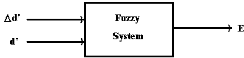
Figura 4.1. – Entradas y salidas del Sistema Difuso (E = Energía de la señal, d' = índice de desempeño).
