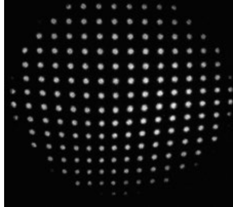
Fig. 4.19 Hartmanngrama de prueba para la lente oftálmica progresiva de -3.00/+2.00 D.
