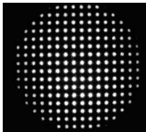
Fig. 4.6 Hartmanngrama de referencia para lente oftálmica de visión sencilla.
