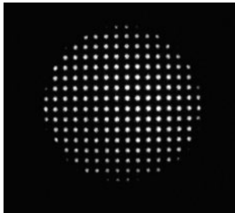
Fig. 4.16 Hartmanngrama de referencia usado en la prueba de lentes progresivas.
