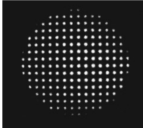
Fig. 4.13 Hartmanngrama de referencia para la lente oftálmica bifocal.
