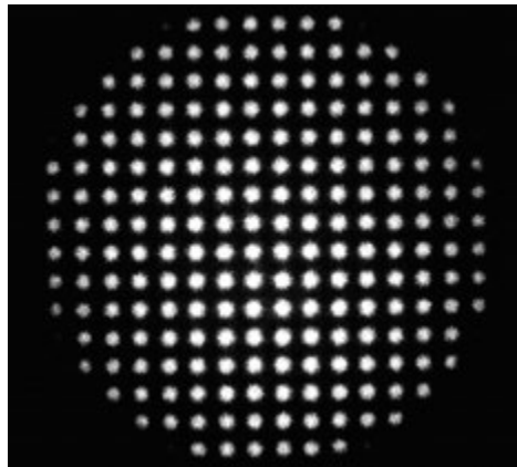
Fig. 4.9 Hartmanngrama generado por la lente oftálmica de visión sencilla (-3 D).
