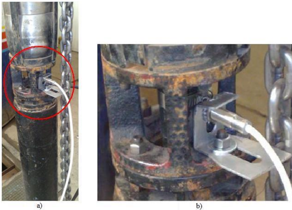
Figura 5.18: a) CMBS con el dispositivo sensor de la velocidad acoplado. b) Cuerpo de succión del CMBS donde que permite observar el sensor, la montura y la abrazadera colocada sobre el rotor.
