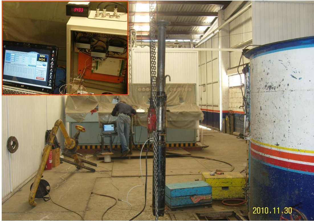
Figura 6.5: Ensayo del equipo VI sobre el CMBS de capacidad 30HP en un laboratorio de pruebas de bombas sumergibles tipo pozo profundo.
