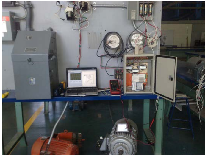
Figura 6.3: Primeros ensayos del equipo sobre 2 motores no sumergibles alimentados a 220V, con capacidad de 30HP y 20HP respectivamente, la velocidad de giro es cercana a 1800rpm en vacío.
