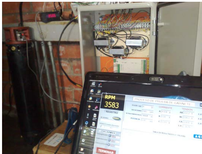
Figura 6.4: Ensayo del equipo utilizando un motor sumergible de 2HP alimentado a 220V, la velocidad de giro detectada seala 3583 rpm, considerando que el motor se encuentra en vacío.
