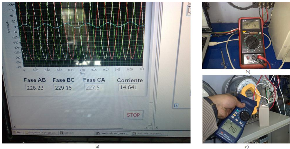
Figura 6.1: a) Panel frontal del equipo versión 1 donde se monitorean las señales de voltaje y corriente en el tiempo, así como los valores en RMS. b) Equipo empleado para la comparación de voltajes, multímetro marca Autonics modelo DM-332. c) Equipo empleado para la comparación de corrientes, ampérmetro de gancho marca Autonics modelo 8EW-3900CL.
