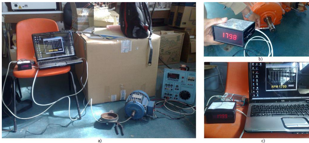
Figura 6.2: a) Elementos principales para la prueba y ajuste del parámetro velocidad del motor. b) Prueba de velocidad para un motor de 1 HP utilizando un sensor inductivo y un pulsómetro como medidor de referencia. c) Comparación entre el equipo de instrumentación virtual y el indicador de referencia pulsómetro marca Autonics serie MP5W.
