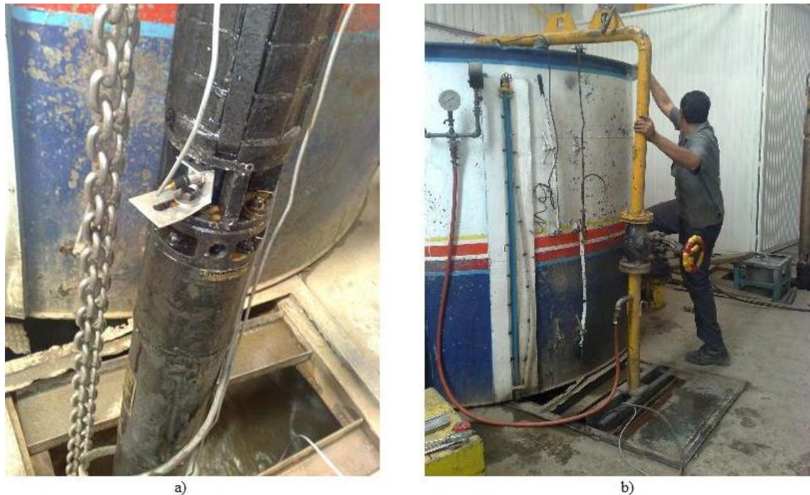
Figura 5.32: a) CMBS con el dispositivo sensor de la velocidad previamente instalado antes de ser sumergido en la piscina. b) CMBS sumergido en la piscina y operando bajo la supervisión constante de un auxiliar del laboratorio de pruebas.
