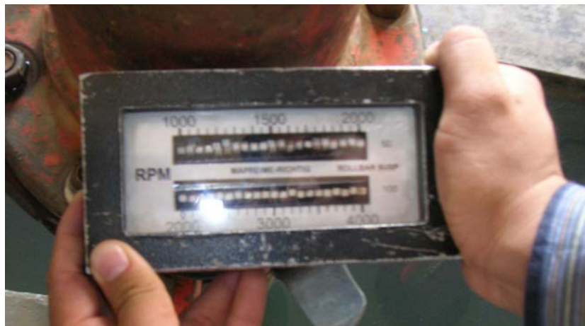
Figura 5.13: Medición indirecta de la velocidad del motor mediante un tacómetro de lenguetas vibratorias.
