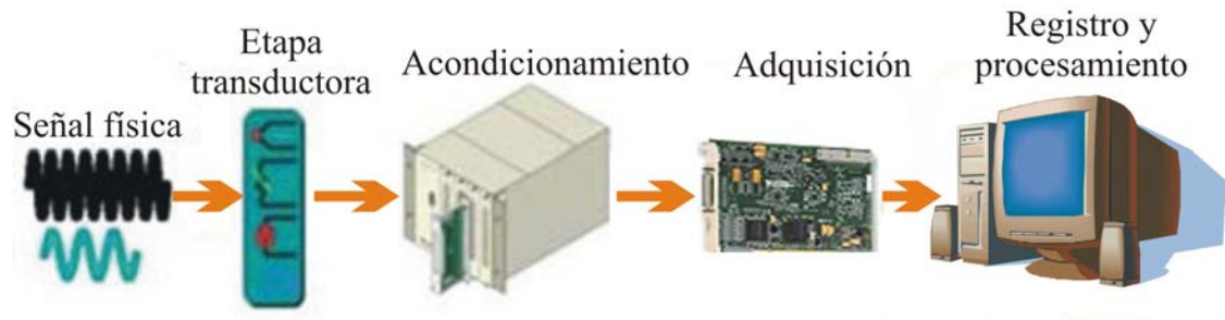
Figura 4.1: Sistema de monitoreo y control de vibración en computadora, a través de una tarjeta de adquisición de datos, acondicionamiento de señal y transductores.
