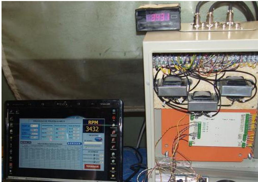
Figura 5.33: Monitoreo y captura de las variables que intervienen durante el proceso de prueba del CMBS, empleando el equipo de instrumentación virtual.
