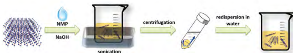
Figura 2.2: Esquema del proceso de fabricación por exfoliación líquida de MBP [28].
