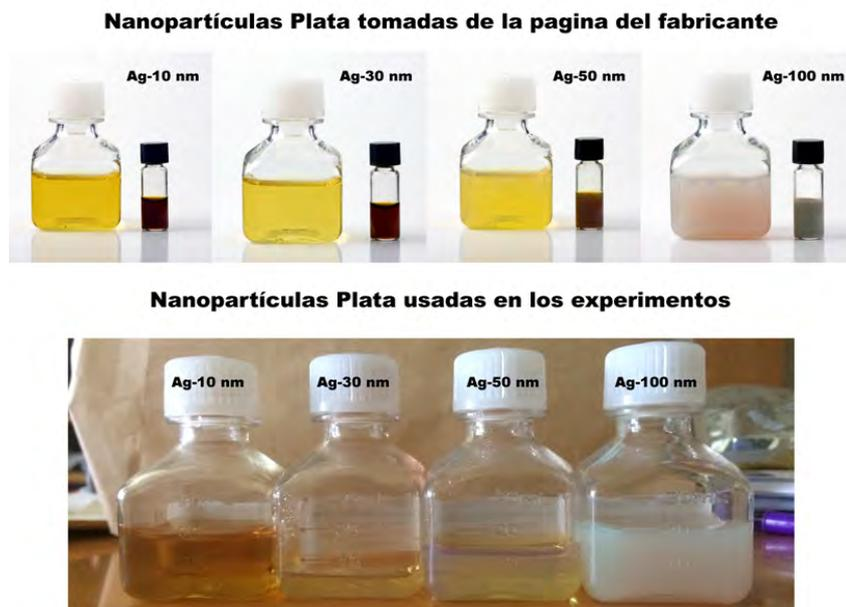
*Figura 3-5. Sistema de nanopartículas de plata a 4 diferentes tamaños. Arriba fotografía del fabricante, abajo fotografía de las muestras usadas en la investigación.*
