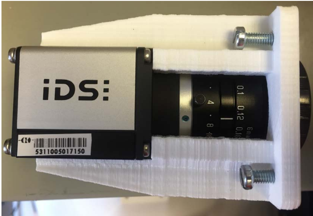
FIGURA 52.-Cámara IDS colocada sobre el soporte que la mantendrá sobre la luminaria.
