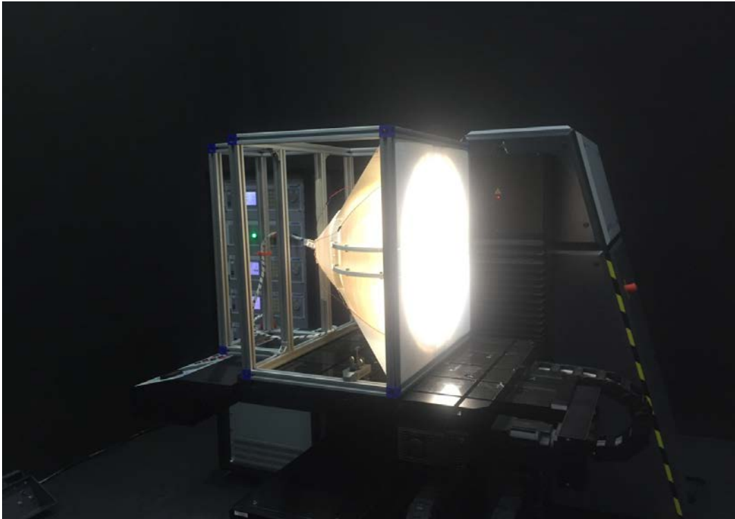
FIGURA 32.- SPOCC montado en goniómetro en el túnel fotométrico del CIO Aguascalientes.
