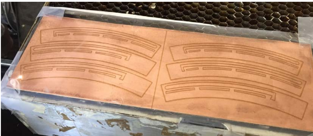
FIGURA 27.- Trazado de pistas en la interfaz plástica, adherida a la placa de cobre, cortada por laser
