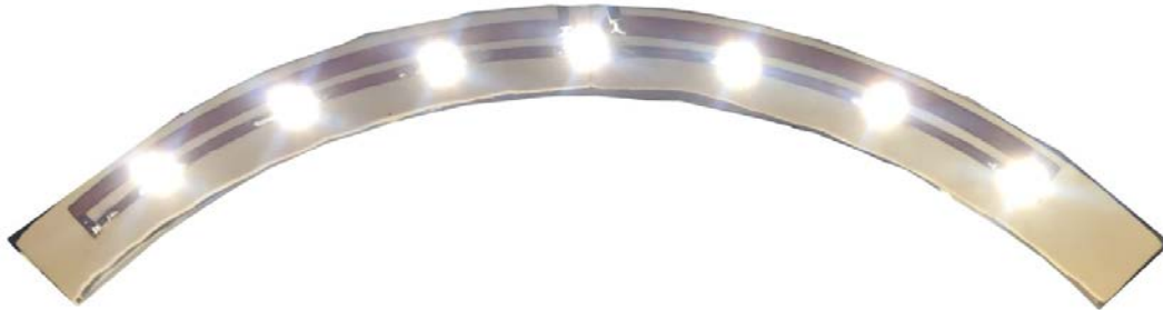
FIGURA 30.- Placa de cobre en forma de arco a 90° con LEDs de montaje superficial.
