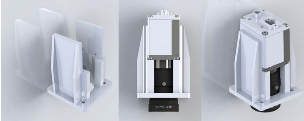
FIGURA 26.- Base para cámara diseñada en SOLIDWORKS®.
