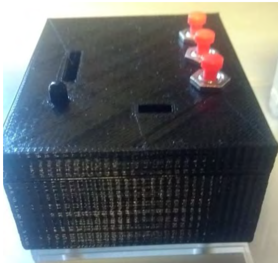
FIGURA 3-14. Carcasa con componentes eléctricos acoplados a la base del arreglo.
