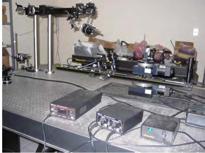
FIGURA 3.2. Fotografía del esparcmetro tipo ARS (Angle Resolved Scattering) utilizado para hacer las mediciones.
