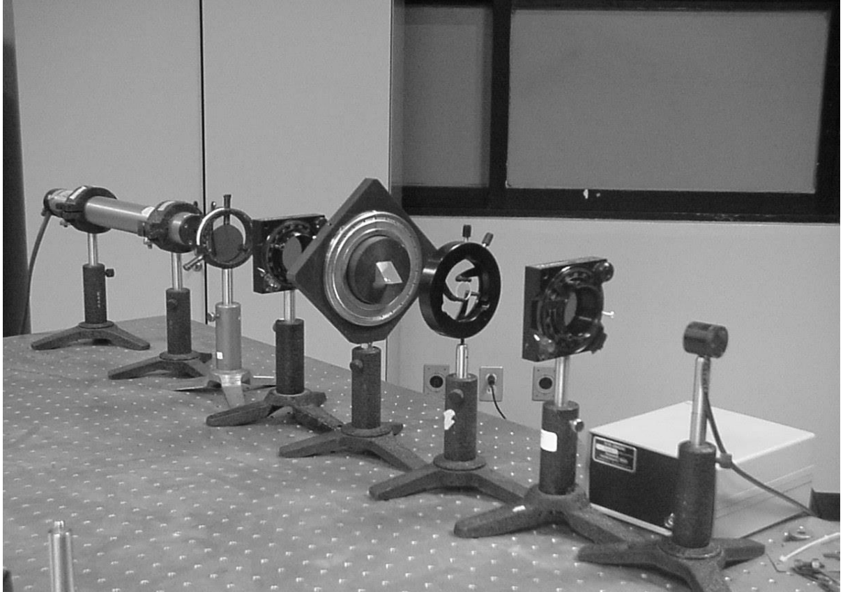
Fig. 3.6 Fotografía del arreglo experimental utilizado en la medición del estado de polarización de un haz de luz a la salida de un prisma Dove rotado. En la figura se observan el láser, polarizadores, el prisma Dove en la base rotadora, una montura con una placa retardadora \lambda/4 y un detector (radiómetro).
