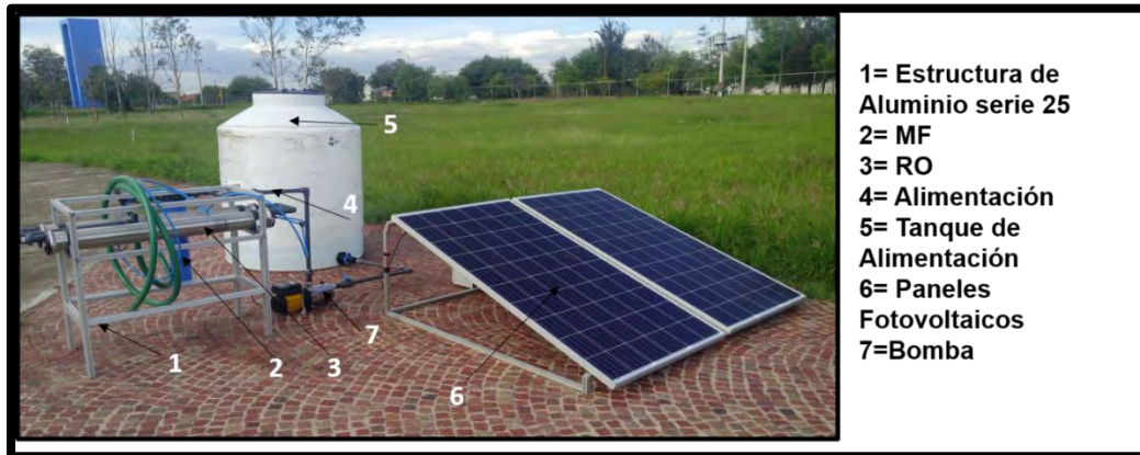
Figura 26. Sistema Desalinizador Construido
