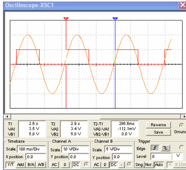
Figura 4.10. Señal senoidal que activa a la bocina, y señal cuadrada que activa el disparo de la cámara Sensicam, sincronizadas.
