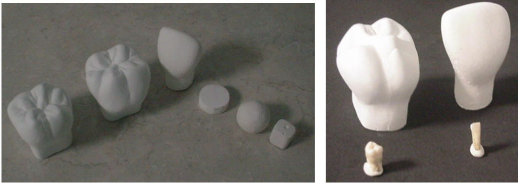
Fig 4.7. Piezas a escala hechas con yeso y muestras son las que se obtuvieron sus propiedades térmicas. Comparación de tamaño con dientes humanos reales.
