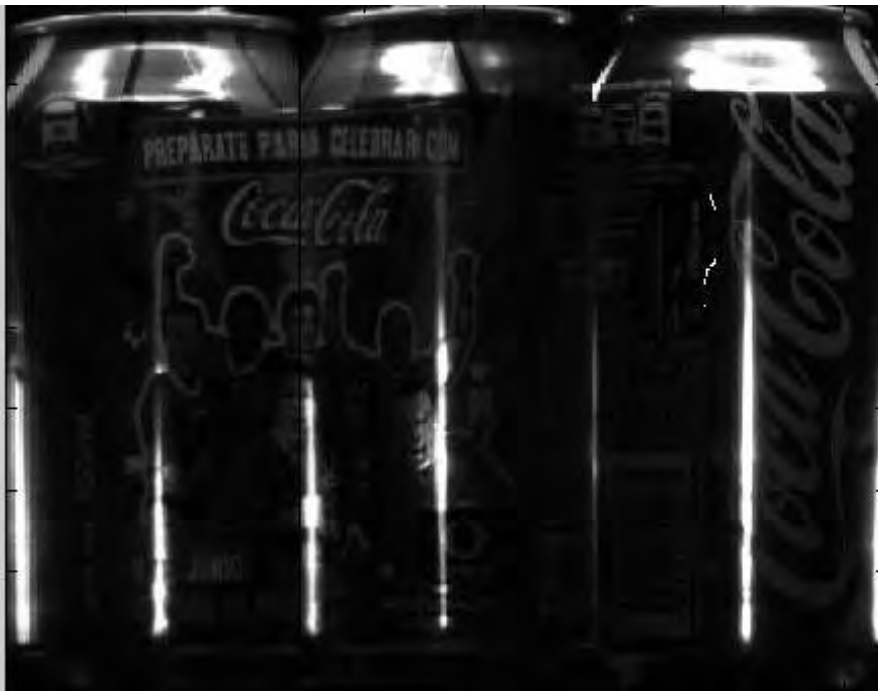
Figura 5.2 Imagen de lata con un rayón como defecto
