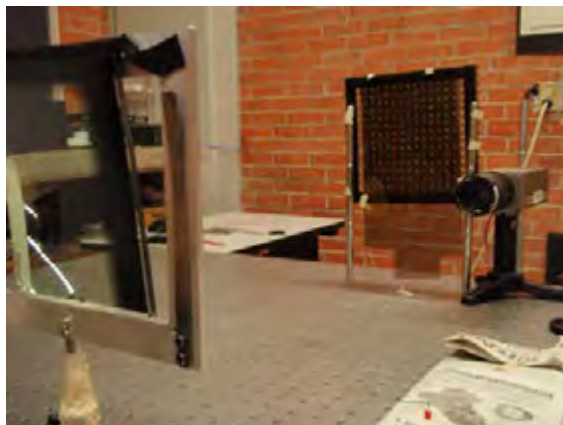
Fig. 3.4: Arreglo de Hartmann modificado.
