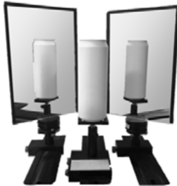
Figura 4.10 Vistas complementarias del objeto proporcionadas por los espejos.
