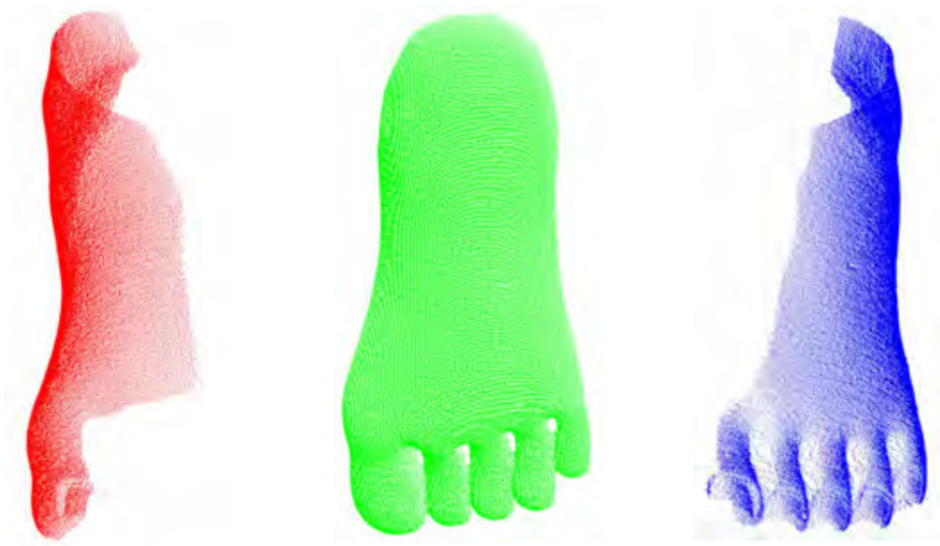
Figura 5.6 Nubes de puntos de cada una de las vistas del maniquí de pie humano.
