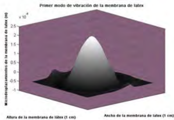
Fig. 3.15 Fase desenvuelta del primer modo de vibración de la membrana de látex a 1.6\text{ kHz} con una amplitud de onda de estímulo a 1.8\text{ V} .
