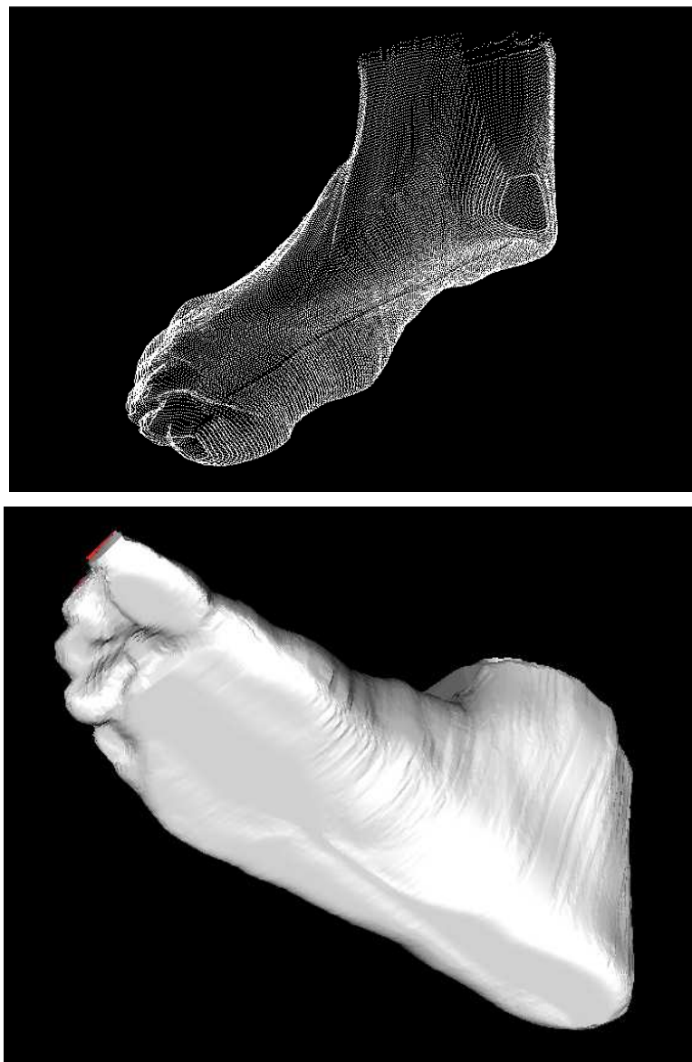
Figura 5.10. Arriba. Visión de la antropometría tridimensional del pie en una nube de puntos. Abajo. Visión de la mismo pie en versión comercial STL.
