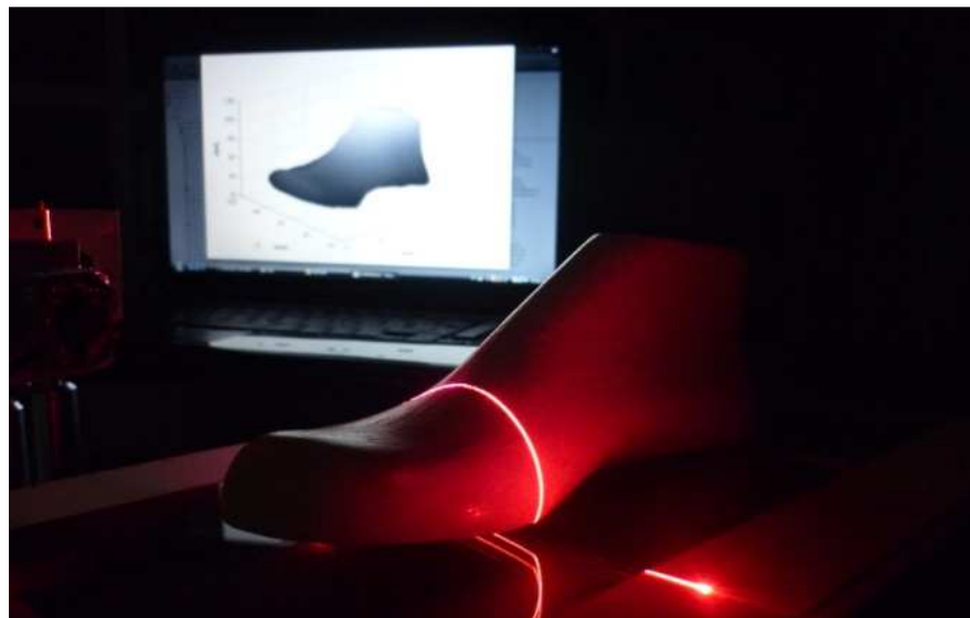
Figura 5.11. Arriba. Barrido láser de una horma para calzado infantil por el prototipo. Abajo. Visión 3D de la horma.
