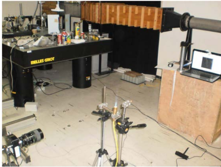
Figura 4.64. Montaje experimental para la técnica BOS
