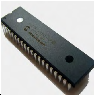
Figura.3.18.- Microcontrolador 18F4550 de la compañía microchip.
