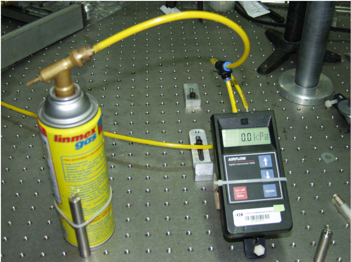
Figura 3.3. Arreglo experimental que muestra la válvula de control del gas y el manómetro de presión para la tobera o soplete.
