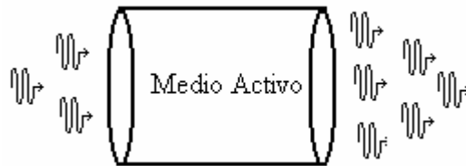
Figura 1.1.4. Amplificación óptica, donde la cantidad de fotones a la salida es mayor que a la entrada.
