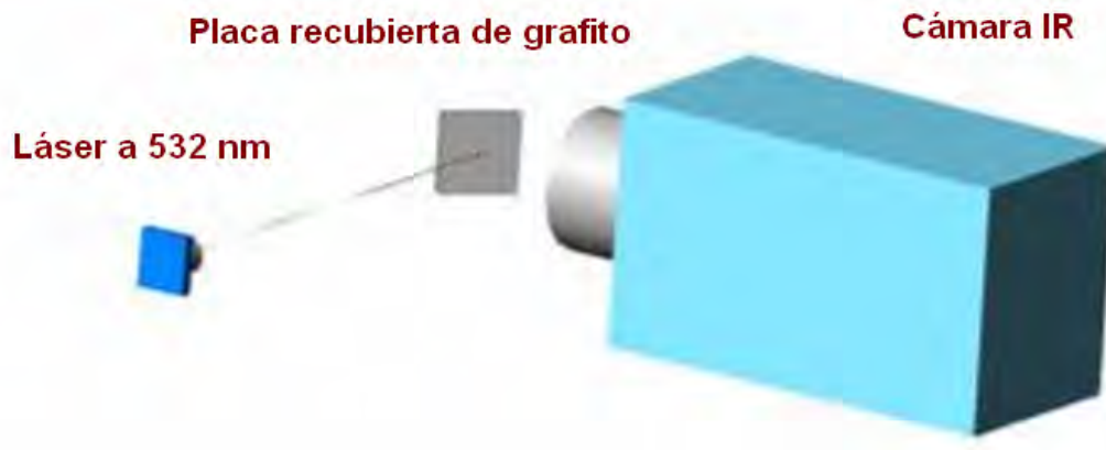
Figura 4.25 Arreglo experimental para generar imagen térmica sobre una placa de vidrio recubierta con grafito.
