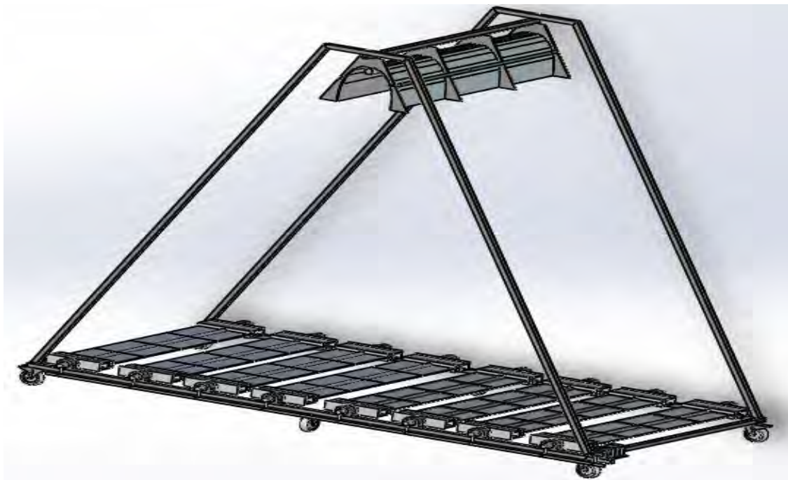
Figura 4.10. Ensamble mecánico general todo el sistema Fresnel de foco lineal.
