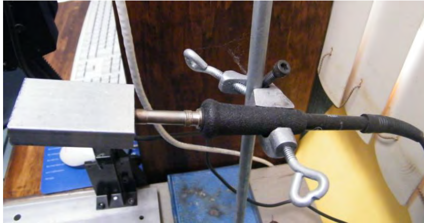
Figura 4.2. Instrumento radiador de IR consta de un cautín unido a una placa de aluminio.
