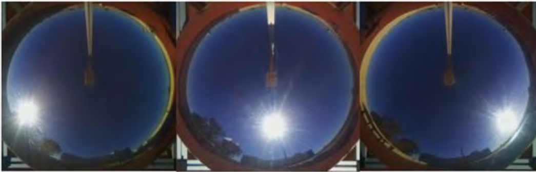
Figura 2.5: Reflejo del cielo completo en el espejo tipo domo.
