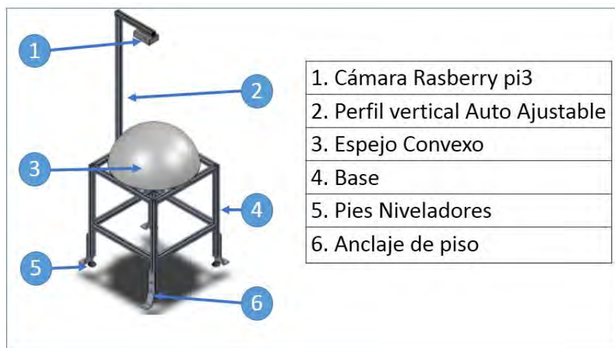
Figura 2.1: Vista preliminar del prototipo (ViSoN).
