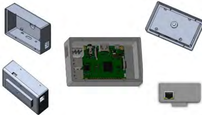
Figura 2.8: Carcasa para placa de Raspberry pi 3B para exteriores.
