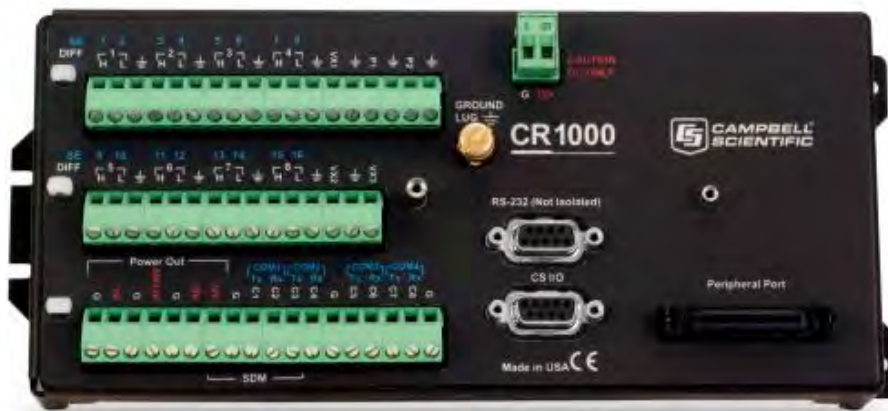
Figura 1.4: Registrador de datos CR1000 Cambell Scientific.
