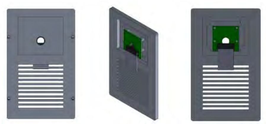
Figura 2.10: Diseño prototipo tapa superior para la carcasa y soporte de cámara.
