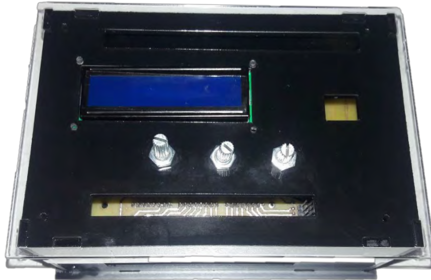
Figura 51. Sistema de control para el prototipo de seguimiento solar.
