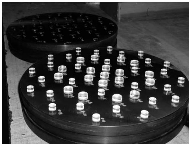
Fig. 2.23 Vista de la cara inferior de las dos herramientas esmeriladoras-pulidoras
