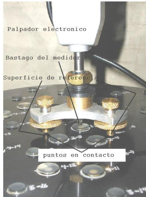
Fig. 4.37 Medición de desgaste real de cada vidrio, respecto al plano de la herramienta
