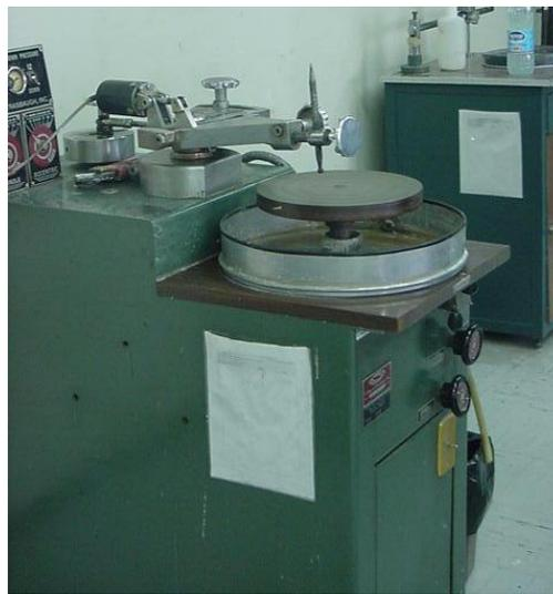
Fig. 3.1 Máquina esmeriladora Strasbaugh modelo 6Y-1
