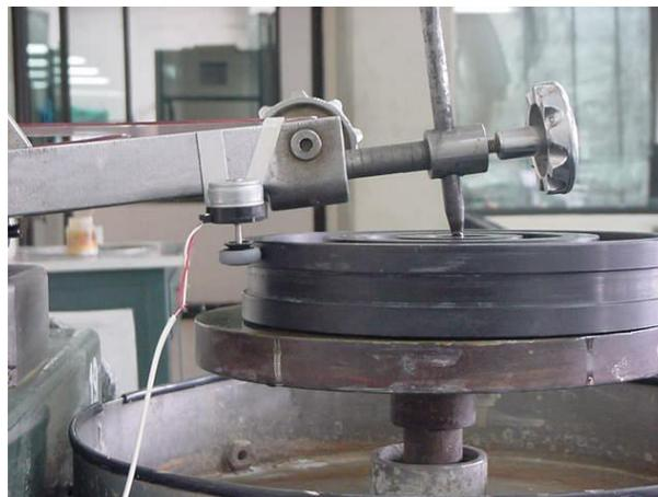
Fig. 4.26 Sensor mediante un pequeño motor de DC
