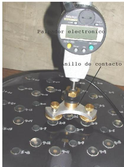
Fig. 4.35 Medición de desgaste relativo de cada vidrio. (Ver también Fig. 4.36)
