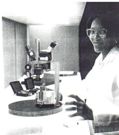
Fig. 1.14 Pulido de una barra láser con herramienta de alta precisión
