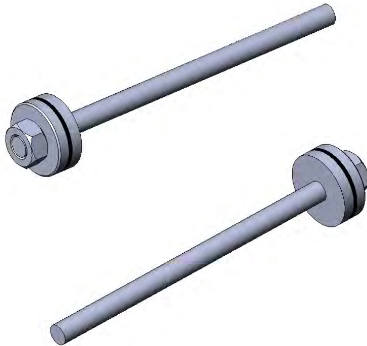
Figura 6.7. Detalle del vástago y embolo del cilindro neumático del robot.
