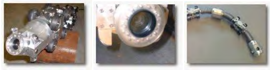
Figura 2.7. Robot pipe crawler de presión contra la pared diseñado por Inspector Systems.
