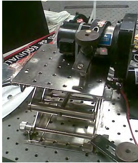
Figura 4.20: Montaje del motor reductor.
