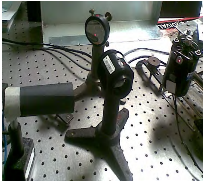
Figura 4.25: Interferómetro Cíclico para analizar el motor de una máquina de coser ropa.
