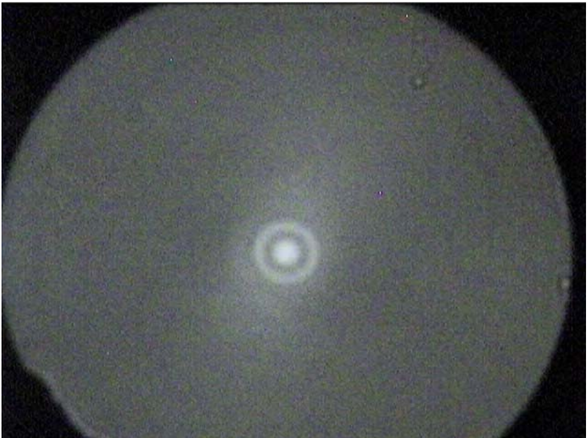
F 2.1. Fotografía de la sección transversal de la fibra de dispersión desplazada donde se observa el núcleo central y el núcleo en anillo.
