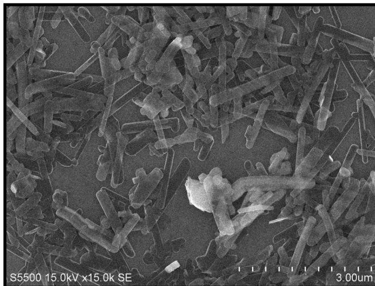
Figura 5.8. Imagen SEM, correspondiente al raspado de nanopartículas de la muestra LB-V-4-M4, tomada a 15.0kV y a 15 mil aumentos, en la cual se aprecian barras.
