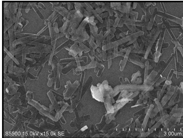
Figura 3.6. Imagen obtenida por medio de SEM, de la muestra AgNP-7-f, donde se confirma la presencia de barras, lo que denota que el proceso de funcionalización, indujo un cambio de morfología.
