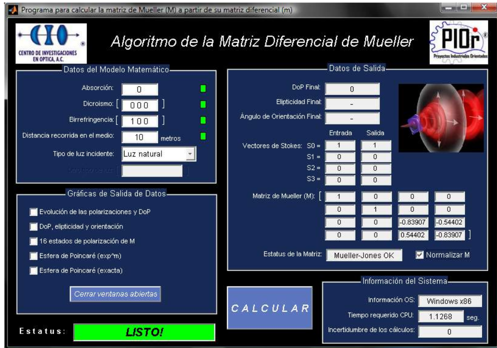
Figura 36: Valores de entrada y salida para el caso de un medio puramente birrefringente.
