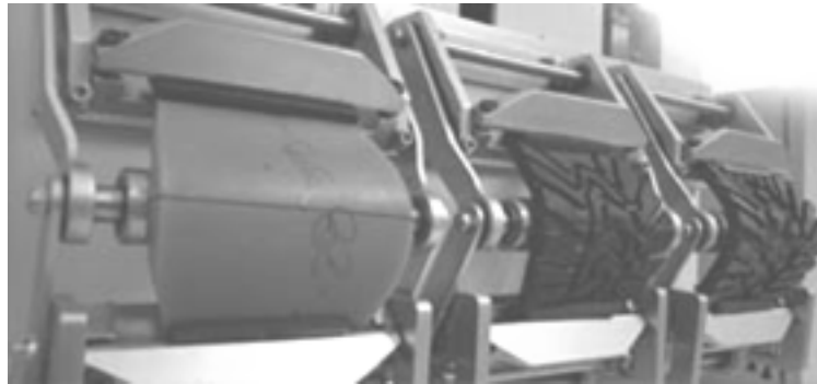
Figura 5.1 Pruebas físicas a la suela.
