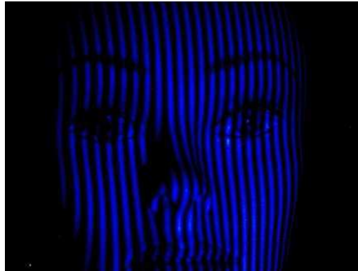
Figura 4.11 Franjas RGB proyectadas sobre el objeto.
