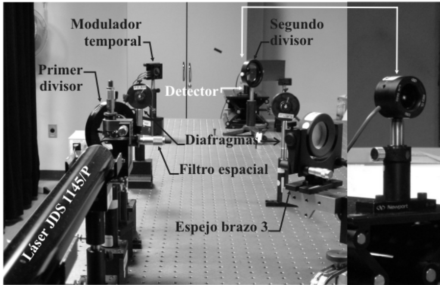
Fig. 4.22 Arreglo experimental con acercamiento al sistema de detección
