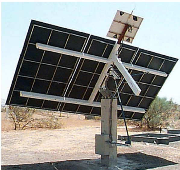
Figura 10. Ejemplo de heliéstato autónomo (Pfahl 2013)
