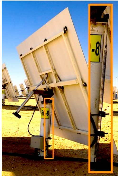
Figura 14. Pretensionado del motor en eje azimutal. (Pfahl 2013)
