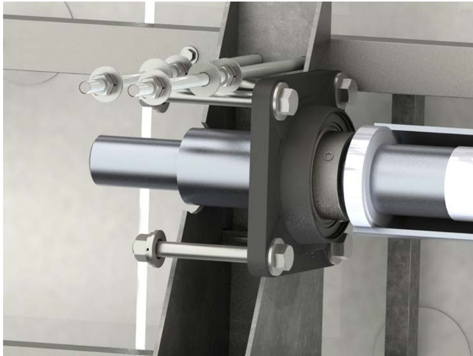
Figura 36. Rodamiento del eje de elevación acoplado al bastidor. (Vista en corte del soporte vertical)
