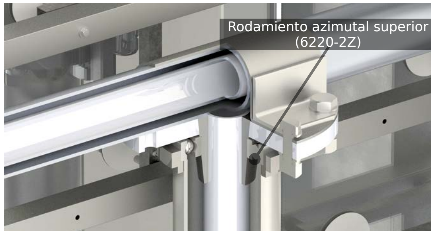
Figura 32. Cabezal vista en corte (rodamiento 6220-2Z)
