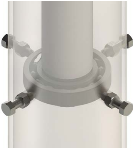
Figura 29. Sistema de fijación del rodamiento inferior del cabezal. (Vista en isométrico)
