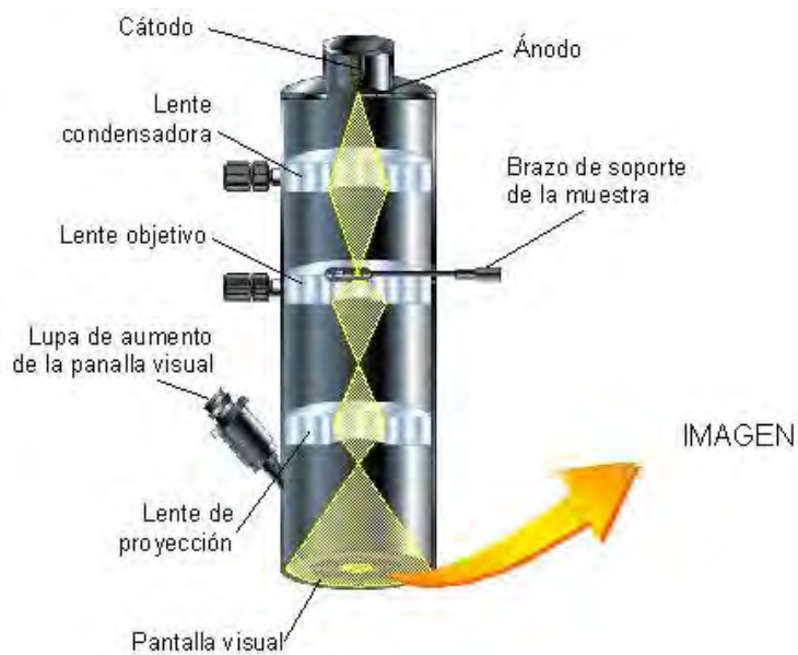
Figura 1.3: Esquema que muestra las componentes y la vía óptica de la radiación Electrónica en el microscopio Electrónico de transmisión (TEM).
