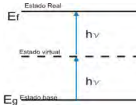
Figura (2.1). Esquema de absorción de dos fotones.
