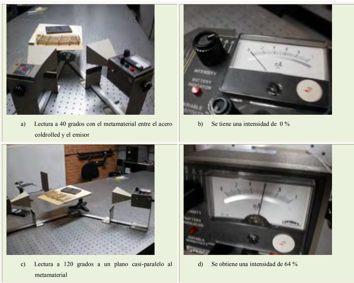
Fig. 3.8 Lecturas Mínima y máxima para acero cold roll (rectángulo de color oscuro), enfrente del acero se encuentra el prototipo de metamaterial.
