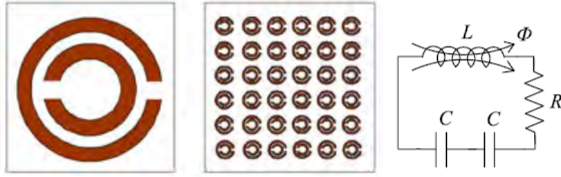
Fig. 2.1.1 esquema de un circuito LC para un metamaterial y su circuito equivalente.
