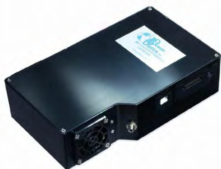
Figura B.8 Espectrómetro de fibra óptica de alta sensibilidad Ocean Optics QE65000 . Detector con un arreglo 2-D de pixels (1044 x 64), responde en el intervalo de 200-1100 nm. Presenta reducción de ruido y señal de fondo lo que permite un tiempo de integración cercano a 15 min, lo que realza el límite de detección en aplicaciones de niveles de baja luz. Tiene un rango dinámico de 25000:1 y una relación S/N de 1000:1. También mostramos las señales de transiluminación registradas a diferentes longitudes de onda: 610, 970, 940, 640, 865, 790, 710 nm cuando irradianos el dedo índice en un joven adulto hombre saludable.
