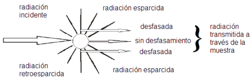
Figura A.1 Tres fenómenos observados cuando un haz coherente se propaga a través de una muestra: esparcimiento (retroesparcimiento, esparcimiento lateral y frontal), absorción, y una porción del haz que no se desvía al pasar por la muestra. La porción del haz transmitido a través de la muestra que presenta atenuación lo representamos por una flecha delgada para indicar los efectos que provoca la absorción en el haz de radiación incidente.
