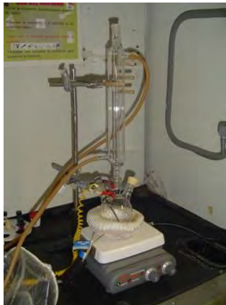
Figura 3.1a: Sistema del proceso de polimerización.
