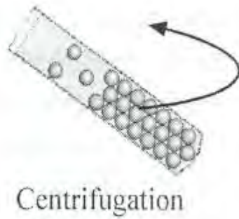
Figura 2.5: Acomodamiento de las esferas debido a la fuerza centrífuga.
