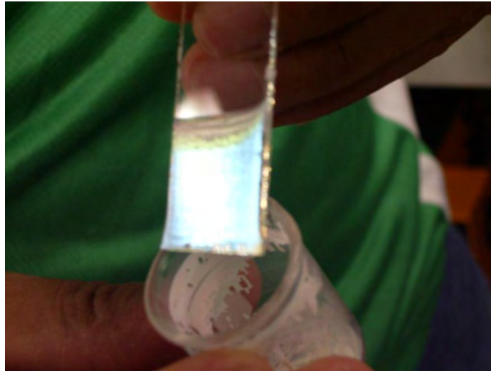
Figura 3.12: Fotografía de una película de esferas empaquetadas y bañadas en silica.
