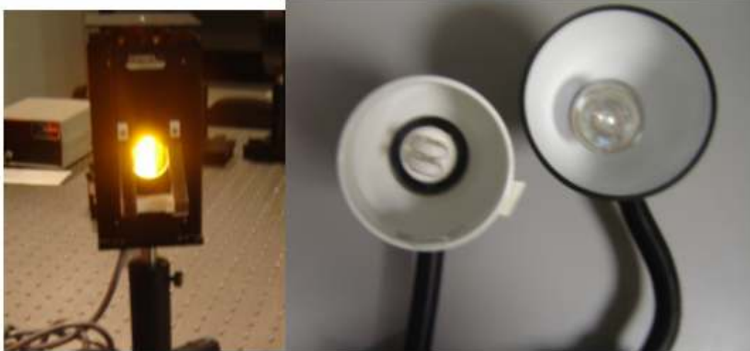
Figura 6.6. Fuente de sodio (izquierda) y fuentes halógenas (centro, halógena, derecha, reflector halógeno) usadas en el ajuste de camino óptico.
