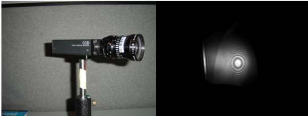
Figura 6.11 Franjas de interferencia (derecha) producidas por un SLD, capturadas con CCD (izquierda).
