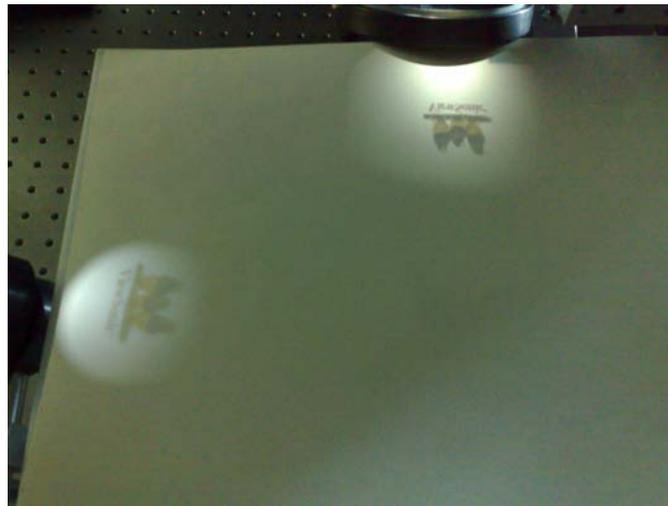
Figura 4.1.7: Proyección obtenida sobre el plano horizontal. Por falta de elementos ópticos y de intensidad de luz del proyector se realizaron sólo 2 proyecciones.
