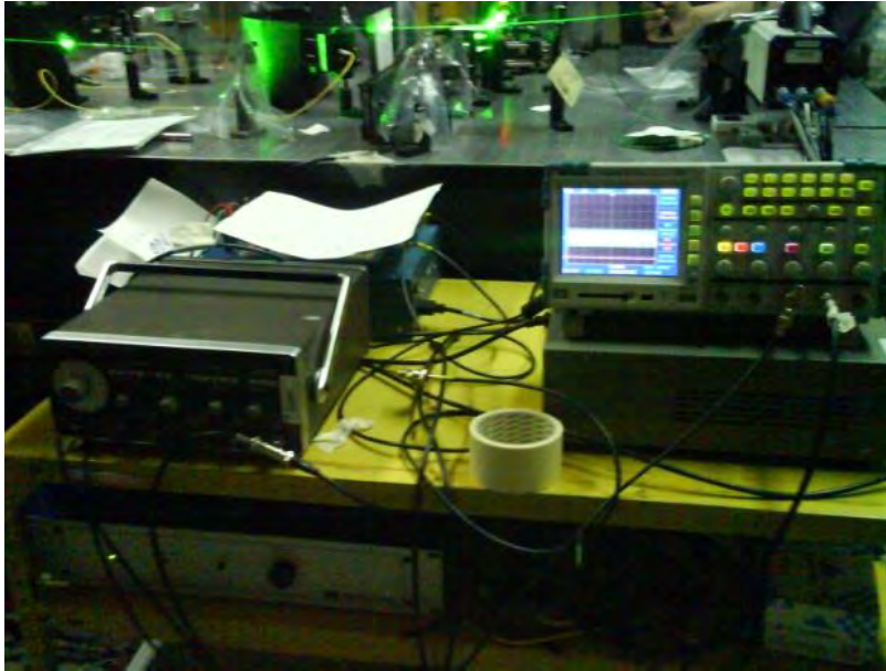
Figura 15. Generador de señales para alimentar la bocina, y osciloscopio para realizar el monitoreo del barrido de diversas frecuencias de sonido (1 khz a 4 khz).
