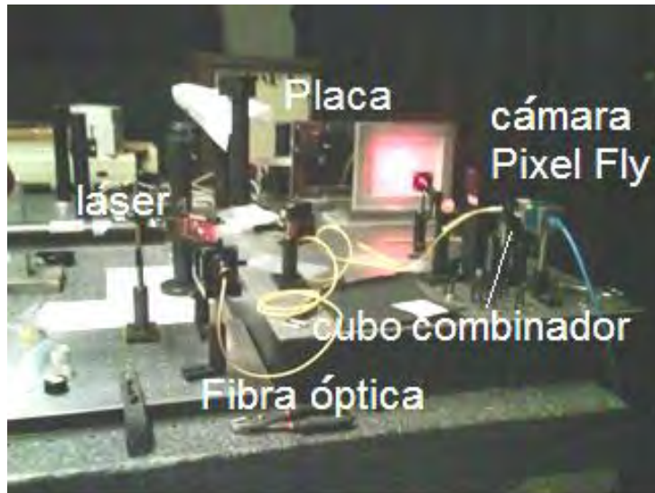
Figura 11. Arreglo experimental para ESPI.
