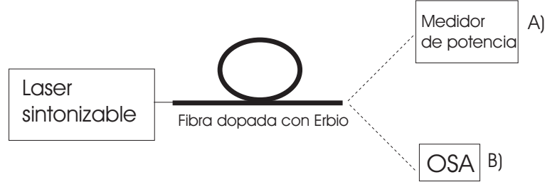
Figura 4.7: Arreglo experimental para obtener A) la transmitancia de \lambda_s a la entrada y salida de la EF y B) el espectro de ASE a la salida de la EF.
