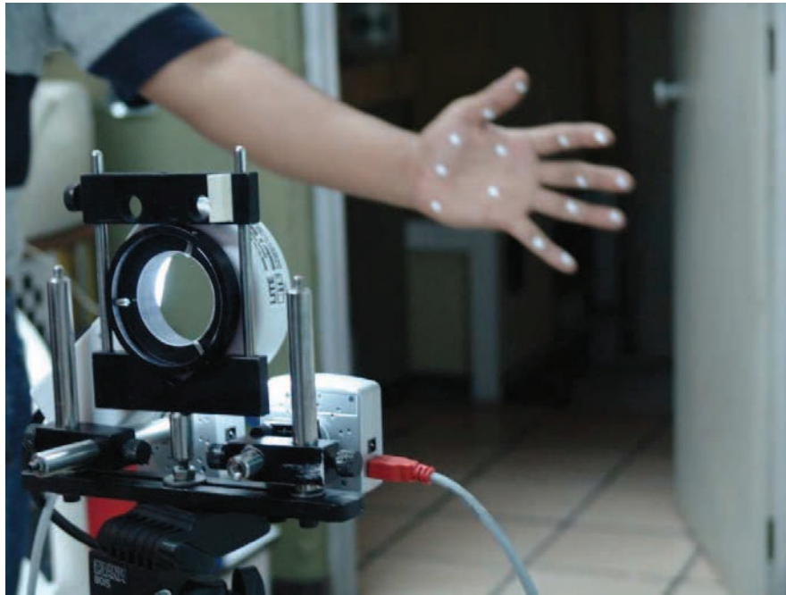
Figura 3.6 Imagen del sistema en funcionamiento mientras se realiza la identificación de los marcadores.
