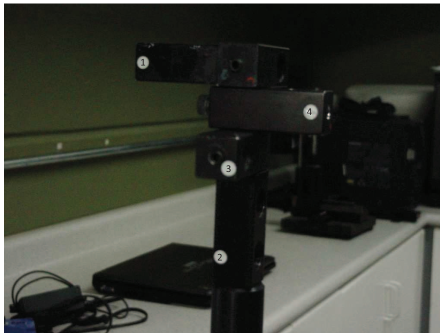
Figura 3.8 Bloques apilados con marcadores colocados sobre ellos para realizar su detección espacial. Las medidas entre cada uno de los marcadores han sido previamente obtenidas.
