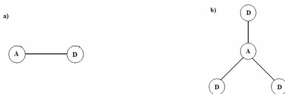
Fig. 1.2 Diagrama de moléculas orgánicas caracterizadas para diferentes dimensiones: a) sistema dipolar y b) sistema octopolar. Las líneas de unión entre los grupos de donador (D) y aceptor (A) denotan puentes conjugados \pi .
