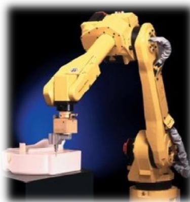
figura 1.3 Brazo manipulador de herramienta
