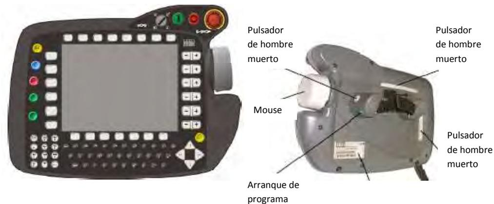
Figura 1.6 Panel de control utilizado como dispositivo de enseñanza
