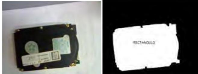
*Figura 1.13* Ejemplo de identificación de forma rectangular
