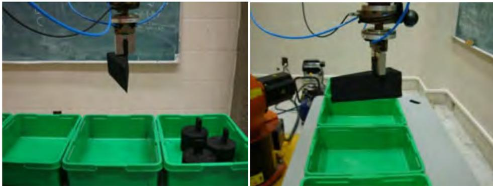
*Figura 4.17 Acomodo de la primera pieza triangular*
