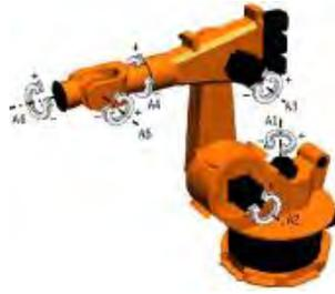
*Figura 4.1 En este sistema los desplazamientos de cada eje son independientes*
