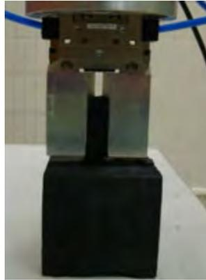
*Figura 4.11 Sujeción de la pieza con el gripper*
