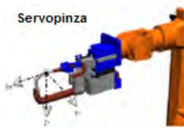
Figura 4.3 En este sistema las coordenadas se mueven respecto a un punto fijo en la herramienta
