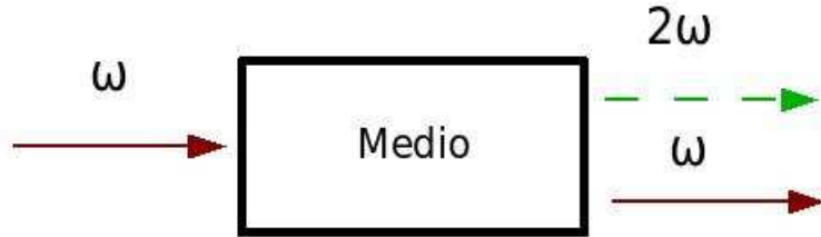
Figura 1.1: Esquema de la generación de segundo armónico. Al hacer incidir una radiación con frecuencia \omega en el medio, este responde generando radiación con frecuencia 2\omega además de la radiación incidente a la frecuencia \omega .
